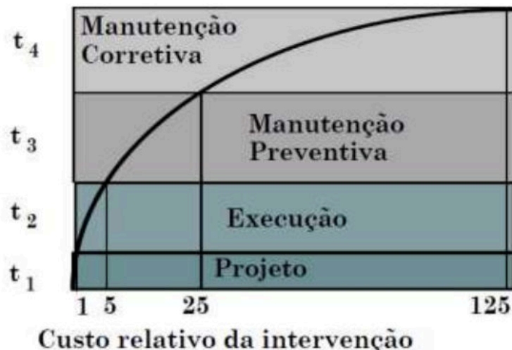
Figura 1: Custo de manutenção ao longo do tempo e em função do nível de intervenção necessária.
